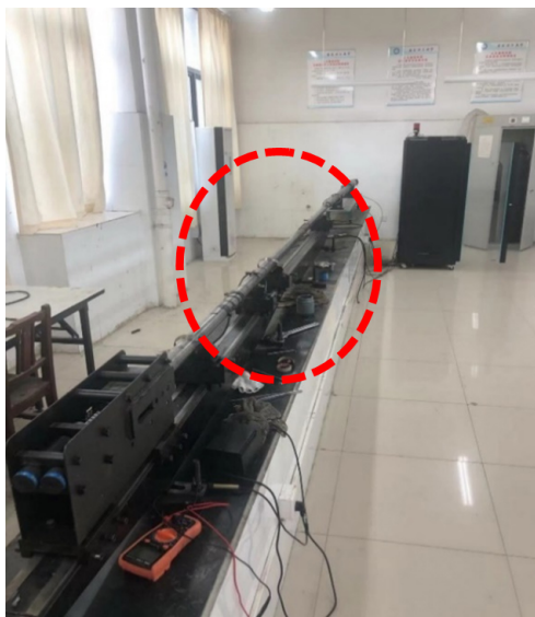
Figure 2. SHPB device system for experiment 图 2. 实验用 SHPB 装置系统
