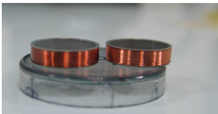
a) 力矩线圈目视图(左为已涂覆绝缘漆, 右为未涂覆绝缘漆)
