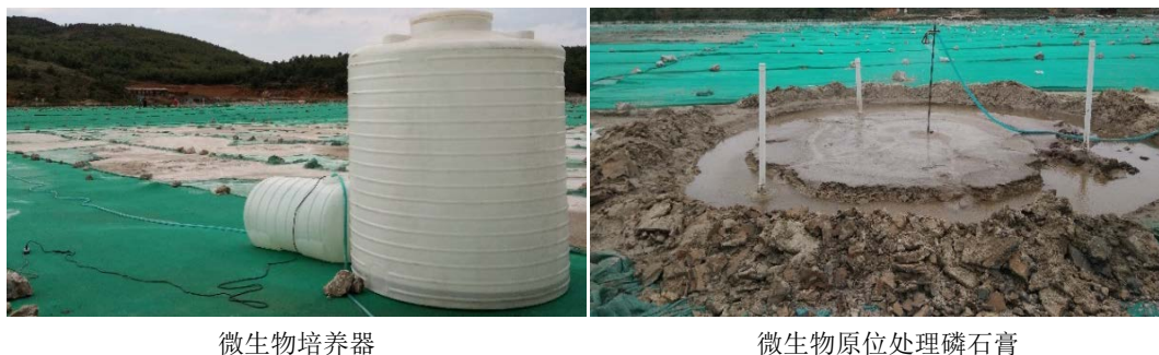
Figure 1. Exploratory test of phosphogypsum biodecomposition 图 1. 磷石膏微生物处理探索性试验
