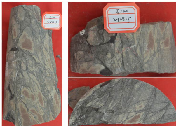
Figure 1. Fault breccia characteristic in JiYang Depression 图 1. 王 100 井 2423.8 m、2425 m 发育断层角砾岩
